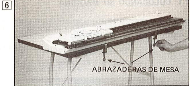
Fije la máquina a la mesa apretando los tornillos de las abrazaderas.
