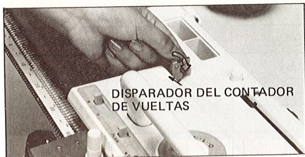
5 Al usar el CONTADOR DE VUELTAS, coloque el DISPARADOR DEL CONTADOR en posición de trabajo.
