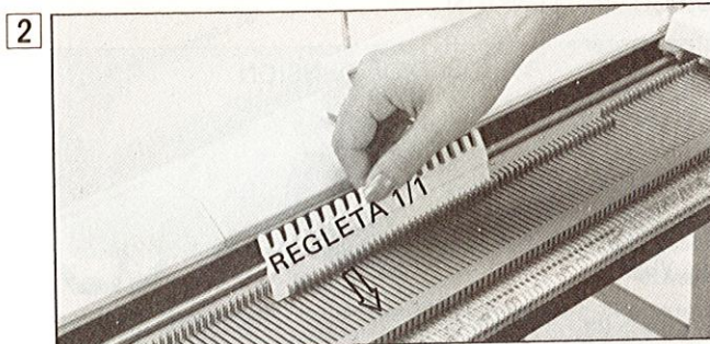
2 UTILIZANDO LA REGLETA 1/1, adelante 60 agujas a la posición "B" 30 agujas de ambos lados de la marca central "0".
