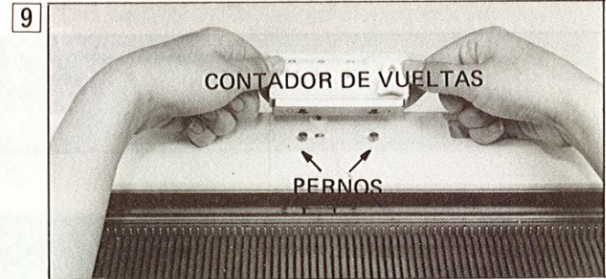
Colocando el CONTADOR DE VUELTAS en los pernos en el centro de la máquina. 1) Coloque el CONTADOR DE VUELTAS en los dos PERNOS.
