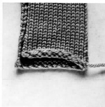
Montaje con 12 pasadas para SEMI-TUBULAR abierto a la izquierda
