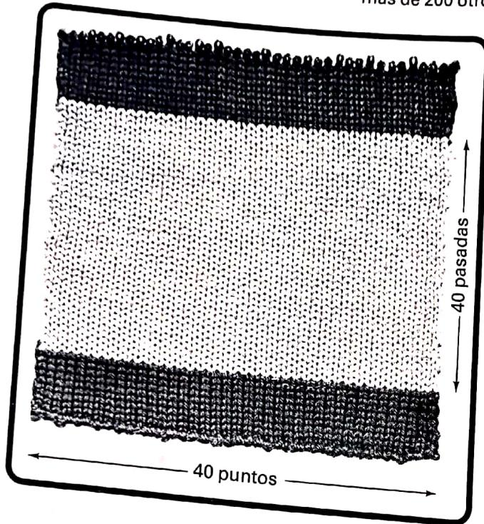
Al tejer con el PASSAP FORM COMPUTER Ud. necesita las medidas en milímetros de una muestra de 40 puntos y 40 pasadas. Para ello, sólo se cuentan los puntos de la cama delantera. Al no tejerse el diseño con todas las agujas de la cama delantera, se mide el ancho del tejido que resulta al tejer sobre un ancho de 40 agujas de la cama delantera.
